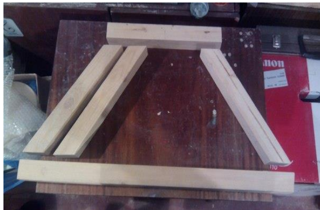
Рис. 1 Вирбельбанк - 32 см (крепление для колков), две боковые стороны (по 32 см), нижняя сторона – 36 см, верхняя сторона – 28 см
